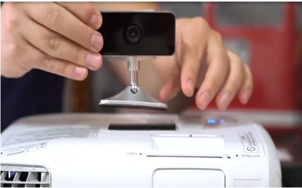
(3) Cole a outra dupla face no projetor e junte ao sensor O sensor deve estar virado para a mesma imagem da projeção
