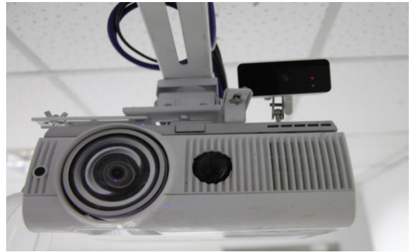
(3) Cole a outra dupla face no projetor e junte ao sensor O sensor deve estar virado para a mesma imagem da projeção
